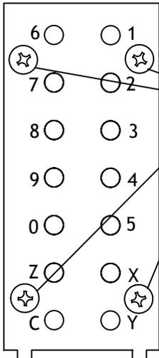
Remettre les quatre vis rouges en place.
