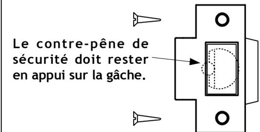
Il est possible de rattraper un jeu exagéré d'alignement gâche-pêne par la pose sur la face intérieure du recouvrement de l'huissierie de tampons en élastomère.
