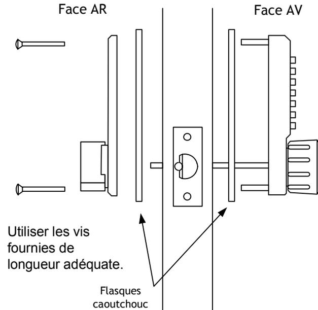
Fixer les deux parties sur la porte avec les flasques en caoutchouc et 2 vis.
